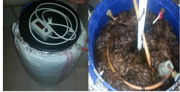
Şekil 3. Deney düzeneği ve su emdirilmiş cam yünü depo donatısı (testing apparatus and tank equipment with water impregnated fibreglass)
