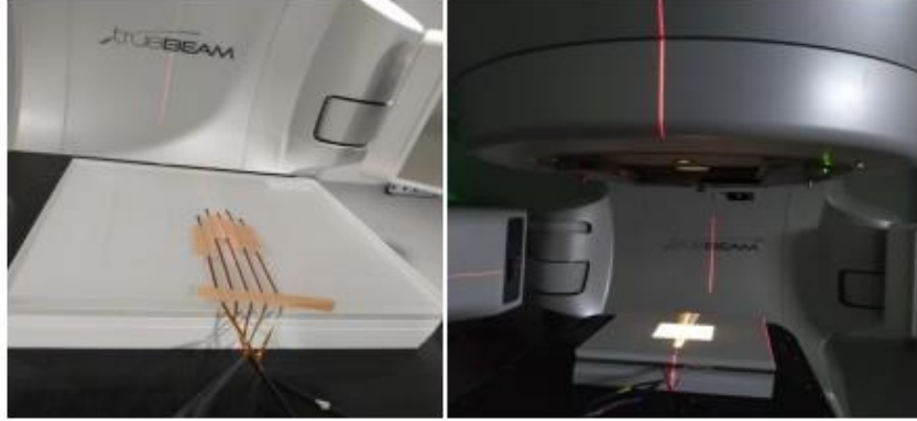
Şekil 6. Mosfet' in Varian Truebeam tedavi cihazında kalibre edilme şekli
