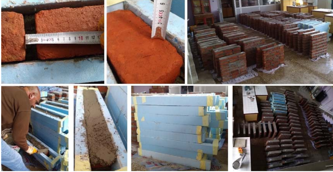
Şekil 5. Duvar elemanlarının oluşturulması süreci (The process of preparing masonry walls)
