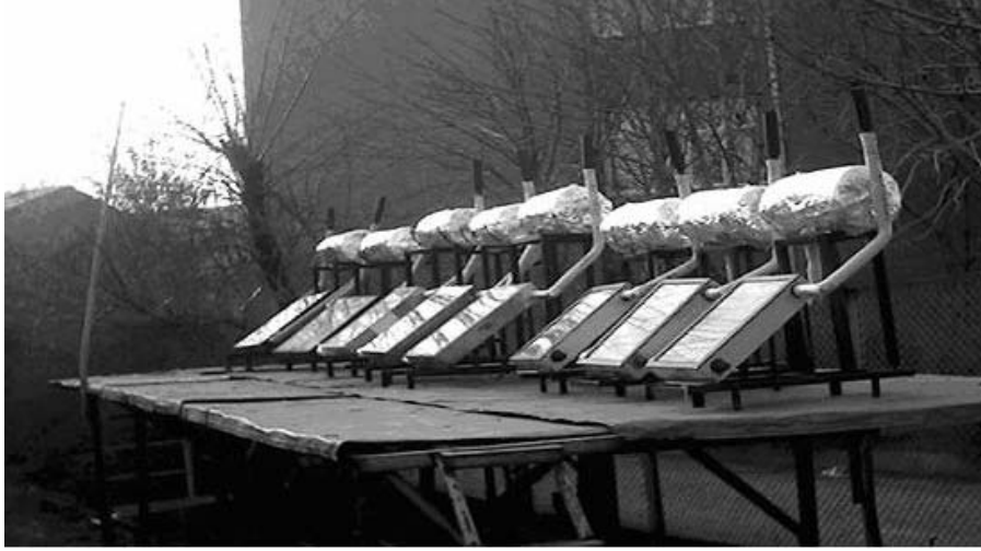
Şekil 5. Deneyi yapılan güneş enerjisi sistemleri
