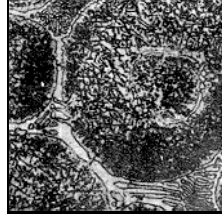
Şekil 3 Dökümden sonra hız çeliği. Ağ şeklindeki karbür ötektikumu [7].
