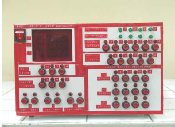
Şekil 2. 3D tarayıcı sistem için geliştirilen elektronik ünitenin önden görünümü.
