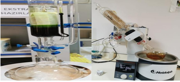
Şekil 1. Bitki örneğinin ekstraksiyon işlemi ve Rotary evaporatör
