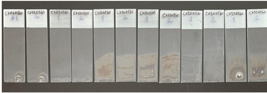
Şekil 9. Farklı beslem oranlarında (solda sağa artan; 02, 05, 10, 15, 20, 25 µl/sn) için üretilen cam/SnO 2 filmlere ait dijital görüntüler.
