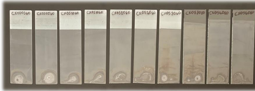
Şekil 8. Farklı büyütme hızlarında (solda sağa artan; 05, 10, 20, 30, 40 mm/sn) için üretilen cam/SnO 2 filmlere ait dijital görüntüler.
