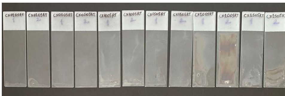
Şekil 10. Farklı besleme oranlarında (solda sağa artan; 02, 05, 10, 15, 20, 25) oda sıcaklığında üretilen cam/SnO 2 filmlere ait dijital görüntüler.
