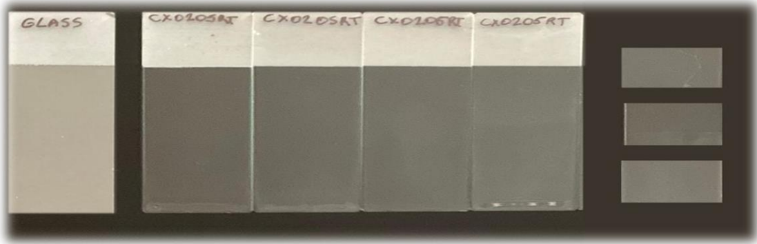
Şekil 12. Optimum koşullarda slot-die tekniği ile üretilen cam/SnO 2 filmlerin boş cam (en solda) ve spin-coater tekniği ile üretilen cam/SnO 2 filmlerin (en sağda) dijital görüntülerinin kıyaslanması
