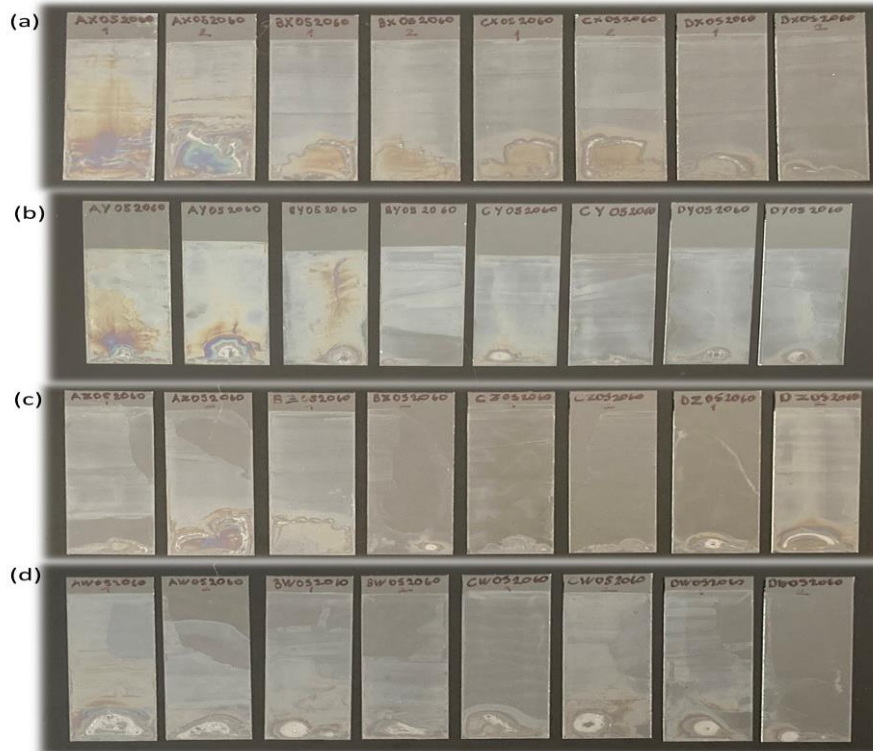
Şekil 5. Farklı konsantrasyon değerleri (solda sağa azalan; A:1/2, B:1/4, C:1/6, D:1/8) için farklı z-mesafesi (yükseklik) (yukarıdan aşağıya artan; (a) 0.1 mm, (b) 0.2 mm, (c) 0.3 mm, (d) 0.4 mm) kullanılarak üretilen cam/SnO 2 filmlere ait dijital görüntüler.
