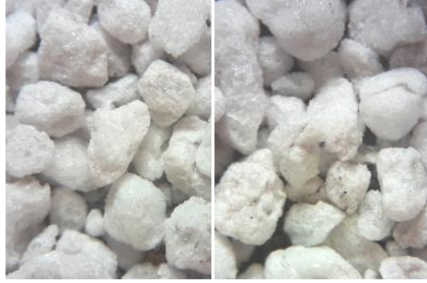
Şekil 4. Genleşmiş perlit agreganın genel görünümü (660 °C) Figure 4. View of expanded perlite aggregate (660 °C)
