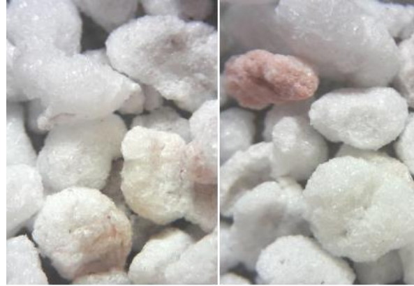
Şekil 5. Genleşmiş perlit agreganın genel görünümü (900 °C) Figure 5. View of expanded perlite aggregate (900 °C)
