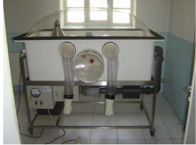
Resim 2. ICPI testinde kullanılan izolator.
