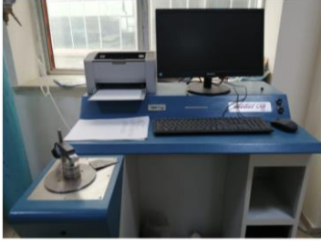
Şekil 1. Numunelerin alaşımlandırılmış içeriklerinin analizleri tespitinde kullanılan spektrometre (Figure 1. The spectrometer used to determine the analysis of alloyed contents of samples)
