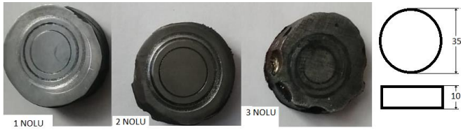
Şekil 9: Farklı yükler uygulanan 1, 2 ve 3 nolu numunelerinin görüntüleri (Figure 9. Images of samples 1, 2 and 3 with different loads applied)
