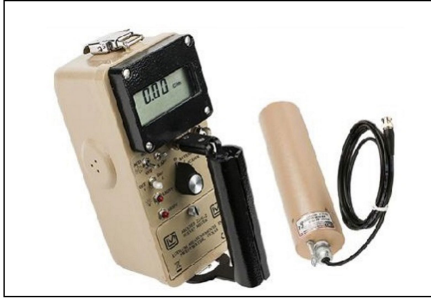
Şekil 2. Ludlum model 2241 dijital taşınabilir gama ölçüm cihazı
