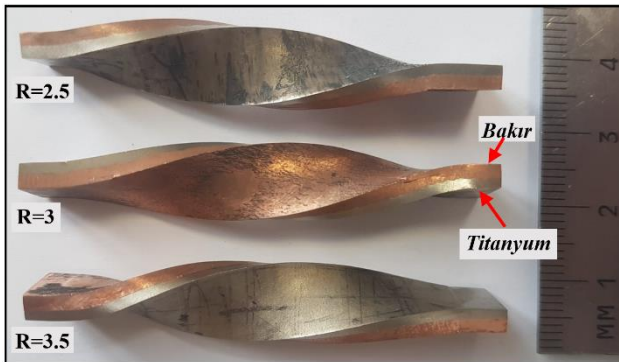
Şekil 14. Burulma testi sonrası numune görüntüleri (Specimen images after twisting test)
