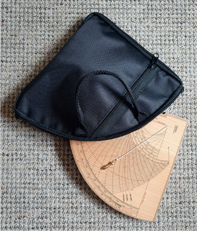
Rubu tahtası, özel çantasının içinde (üstte ve altta). Çantanın içinde çekül için minik kapaklı bir cep ile bilgi kartı için bir şeffaf cep vardır.
