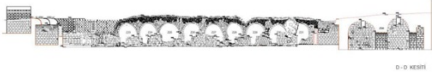
Şekil 7. Doğu Cephesinde bulunan 9 revak görünüşü (Gaziantep Büyükşehir Belediyesi Restorasyon Kurulu Arşivi, Erişim Tarihi: 2019)
