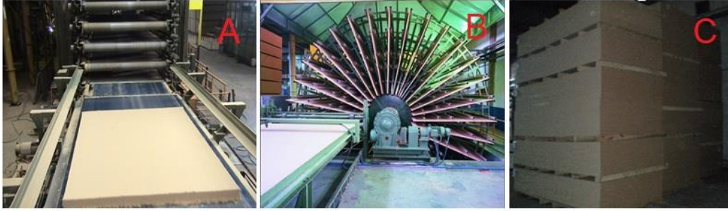
Şekil 1. Üretim süreçleri; A) pastanın asansöre yüklenmesi, B) levhalarının klimatize edilmesi ve C) levhaların depolanması.
