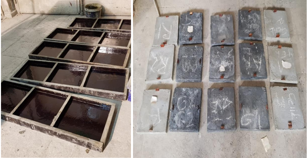
Şekil 3. Deney Elemanlarının Beton Döküm Öncesi ve Sonrası Görünüşleri
