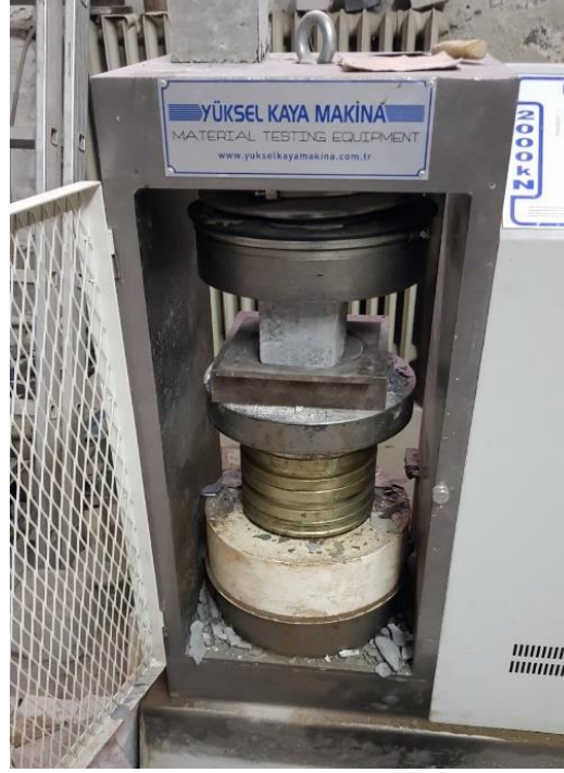
Şekil 4. Deneysel Çalışma Kapsamında Üretilen Beton Karışımlarının Eksenel Basınç Dayanımının Belirlenmesi
