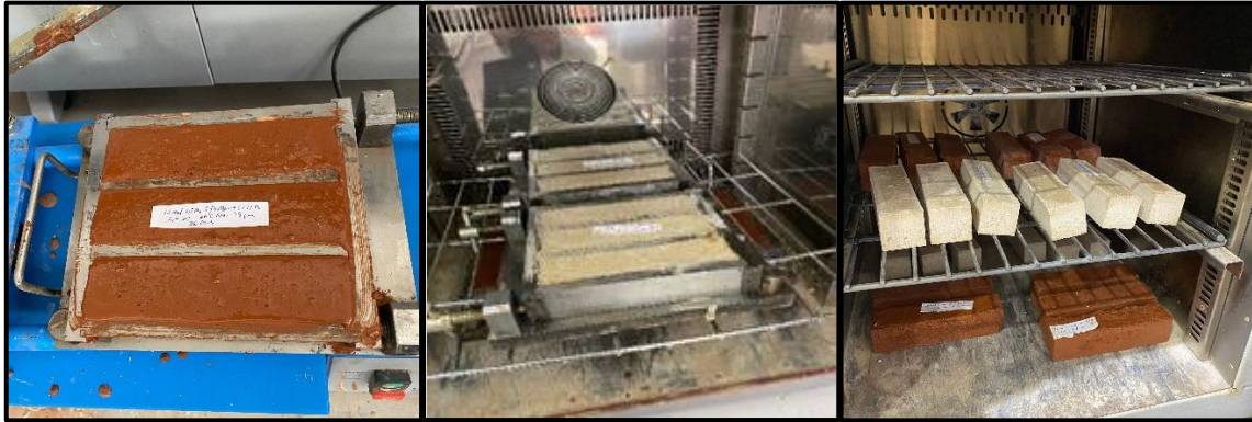
Şekil 4. Üretilen jeopolimer harçlar ve etüvde kür işlemleri.
