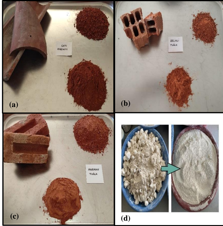
Şekil 1. a) Çatı kiremiti (ÇK), b) Delikli tuğla (DT), c) Harman tuğlası (HT) d) Mermer atığı (M).
