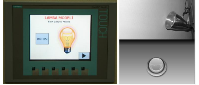
Şekil 7. Lamba animasyonu bilgisayar ekranı ve operatör panel görüntüsü
