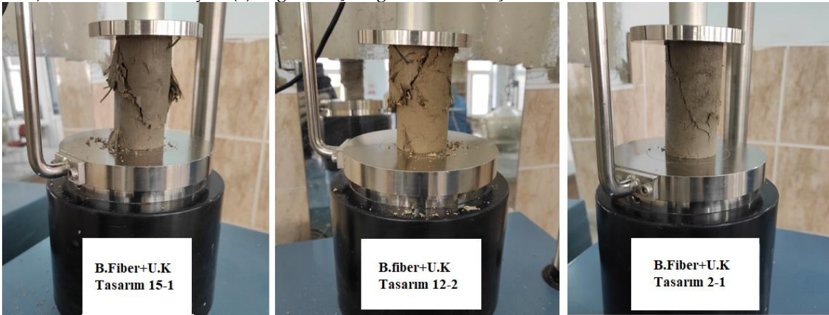
Şekil 5. Serbest basınç deney numuneleri Figure 5. Unconfined compressive test samples
