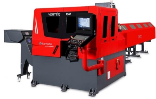
Şekil 1. Otonom yüksek performanslı Vortex daire testere makinesi.
