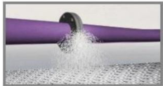
Şekil 12. Contada Meydana Gelen Kaçak veya Sızıntı [14]
