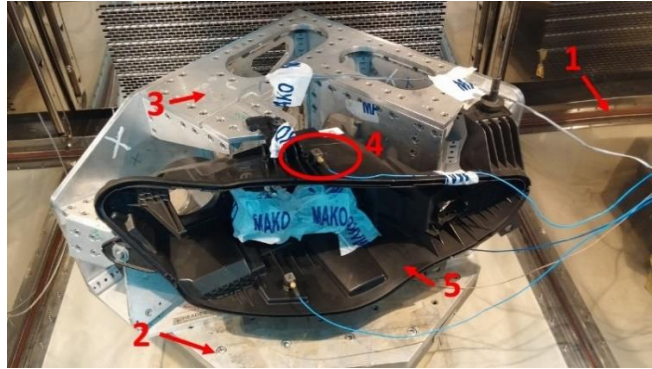
Şekil 1. Doğal frekans tarama test düzeneği.
