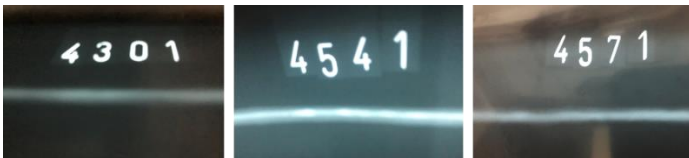
Şekil 3. AISI 304 (1.4301), AISI 321(1.4541) ve AISI 316Ti (1.4571) numuneleri için radyografik muayene görüntüleri
