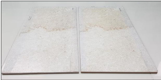
Şekil 5. D-STD ve D-ATK sır kompozisyonlarının aynı gramajda desen halleri.
