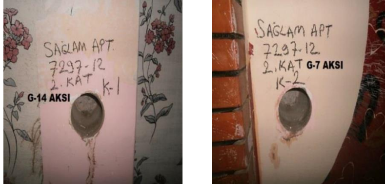
Şekil 4. Beton dayanımı düşük olduğu belirlenen yerlerden karot alınması (Coring from places where concrete strength is determined to be low)
