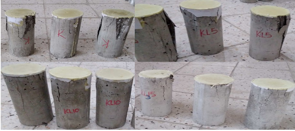
Şekil 6. Lastik katkılı betonlarda kırılma şekilleri (K, KL5, KL10 ve KL15)
