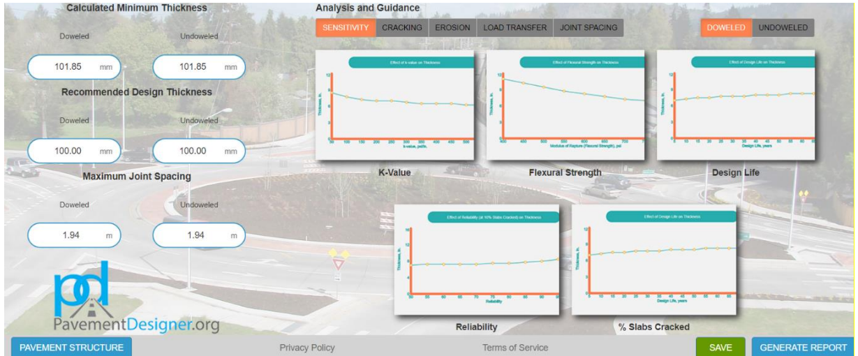
Şekil 5. PavementDesigner'a girilen verilerin sonucu elde edilen kaplama kalınlığı ve duyarlılık (sensitivity) grafiklerinin gösterimi
