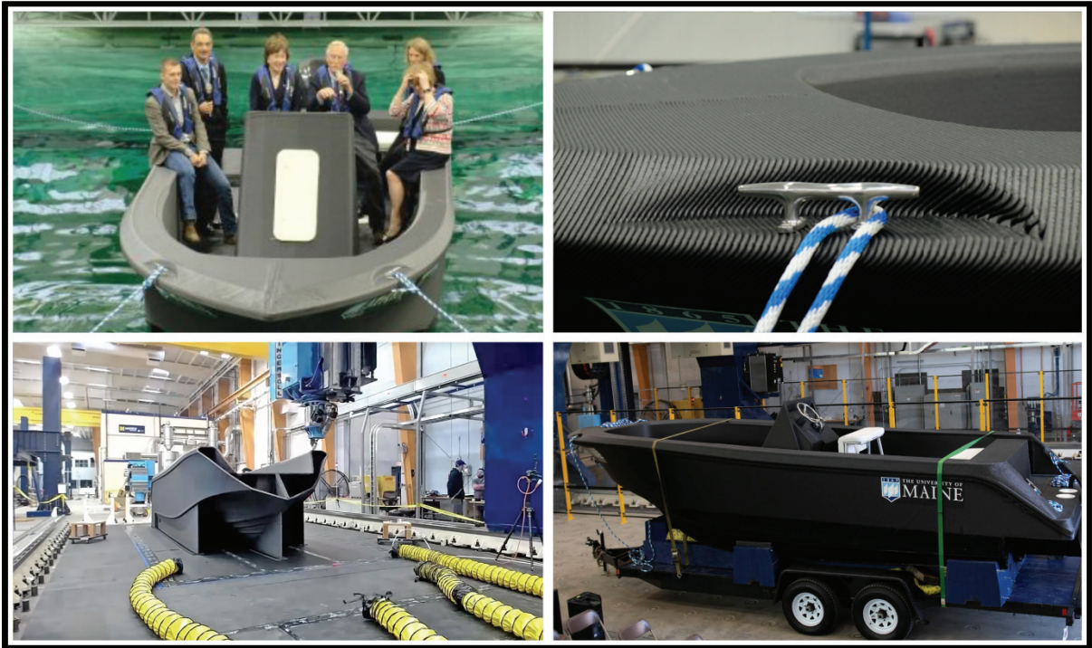
Şekil 1. Maine Üniversitesi İleri Kompozit Malzemeler Merkezi'nde üç boyutlu yazıcı ile üretilen tekne, (İleri Kompozit Malzemeler Merkezi, 2019)
