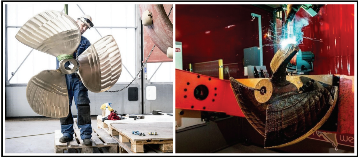
Şekil 3. Eklemeli imalat yöntemiyle üretilen gemi pervanesi, (RAMLAB, 2017)
