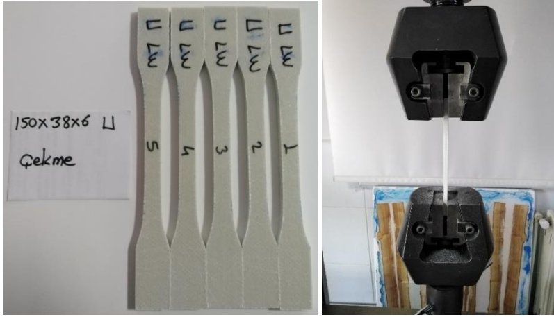
Şekil 6. Çekme deneyi testi için hazırlanan numuneler ve deneyin yapılışının görünüşü
