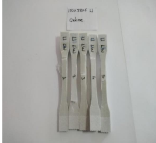
Şekil 7. Çekme testi sonrasında numunelerde meydana gelen hasara ait görüntü
