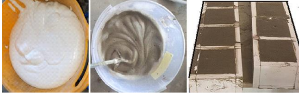
Şekil 4. Köpük harç üretimi ve kalıplanması (Foam mortar production and molding)
