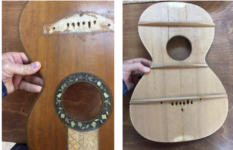
Fotoğraf 13. Romantik gitarın ön tahtasının dış ve iç görünüşü.
