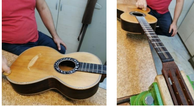
Fotoğraf 27. Romantik gitarın cilasının yapılması.
