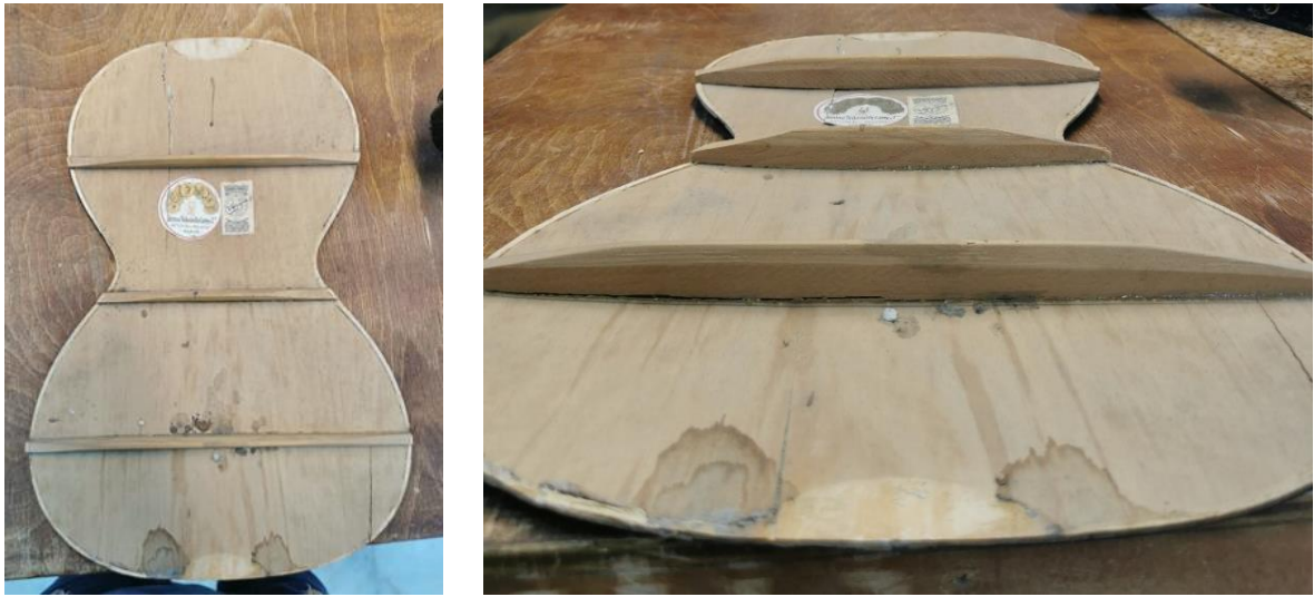
Fotoğraf 4. Romantik gitarın arka tahtasının iç görünüşü ve kirişlerin kesitleri.
