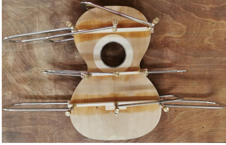
Fotoğraf 18. Ön tahta kirişlerinin yapıştırılması.
