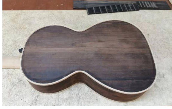
Fotoğraf 23. Romantik gitarın ön ve arka tahta kenarlarına akçaağaç kenar çitası yapıştırılması.
