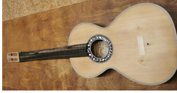
Fotoğraf 26. Klavyesi yapıştırılan romantik gitar.
