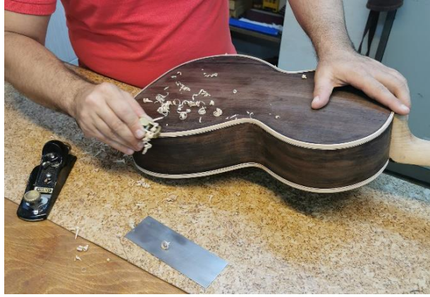
Fotoğraf 24. Romantik gitarın ön ve arka tahta kenar çitalarının temizliği.
