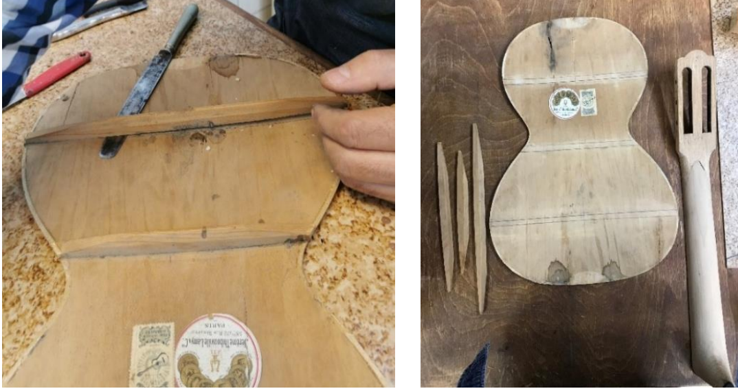
Fotoğraf 5. Romantik gitarın arka tahta kirişlerinin sökülmesi.
