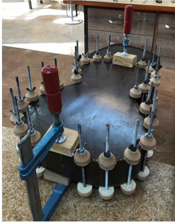
Fotoğraf 10. Romantik gitarın arka tahtasının yerine yapıştırılması.
