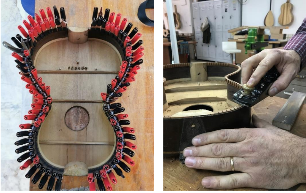
Fotoğraf 9. Romantik gitar yanlığının içine mukavemet çitaları yapıştırması ve tesviye edilmesi .
