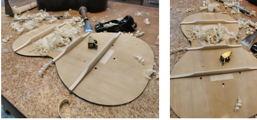
Fotoğraf 19. Ön tahta kirişlerinin şekillendirilmesi.
