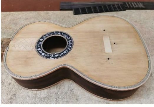
Fotoğraf 23. Romantik gitarın ön ve arka tahta kenarlarına akçaağaç kenar çitası yapıştırılması.
