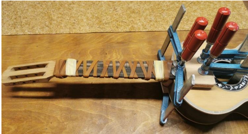
Fotoğraf 25. Romantik gitarın klavyesinin yapıştırılması.
