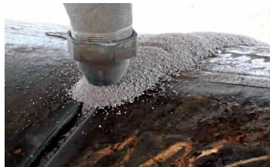
Şekil 1. Tozaltı ark kaynak yöntemi
