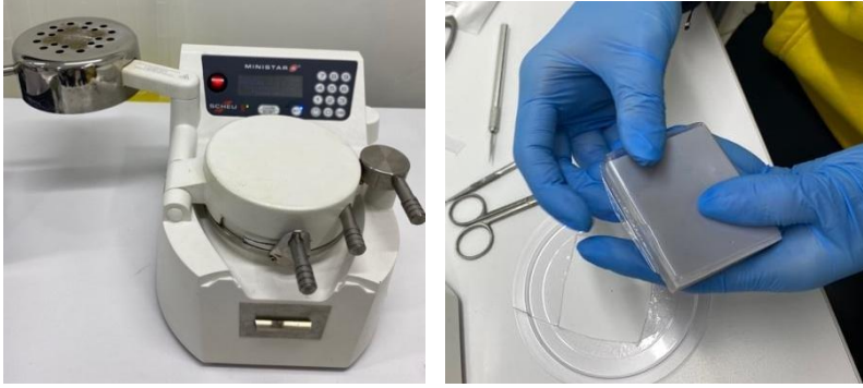
Resim 2. A) Ministar (Scheu Dental) plak vakum cihazı B) Plakların kare kalıplara basılmış hali
