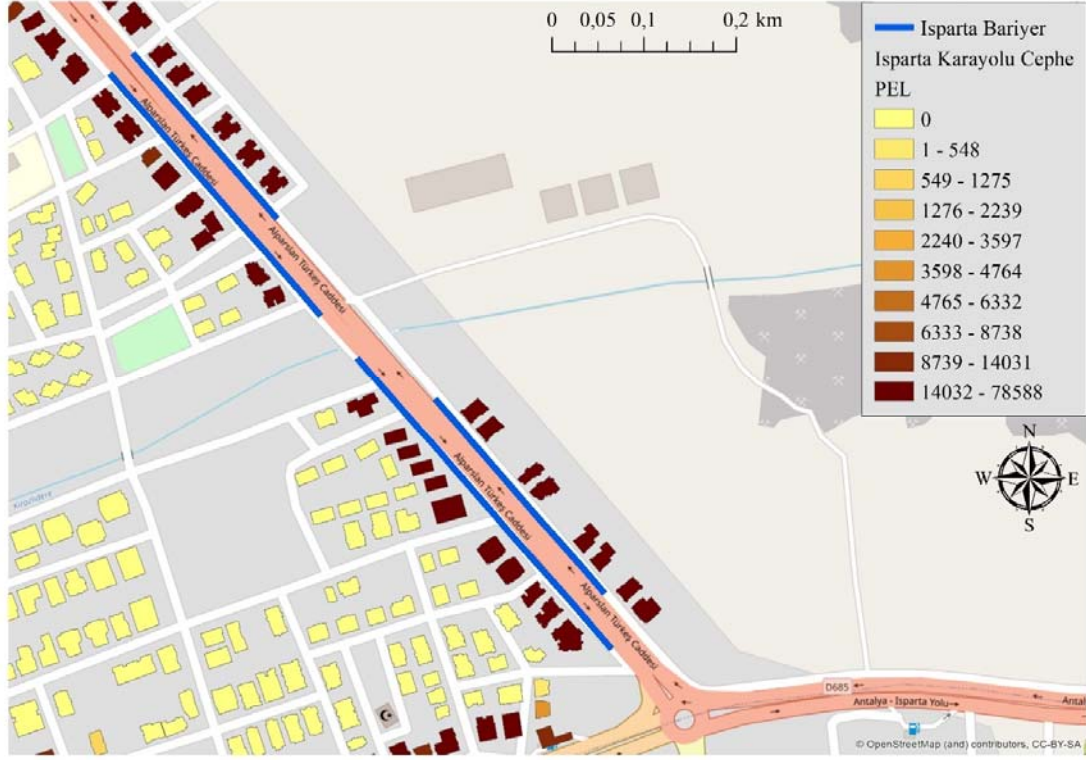
Şekil 5. Isparta ili için belirlenen bariyer sistemleri uygulanabilir potansiyel kesitlerden birkaçı (A few of the potential sections of the noise barrier determined for the province of Isparta)
