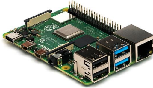
Şekil 1. Raspberry Pi 4 4GB.
