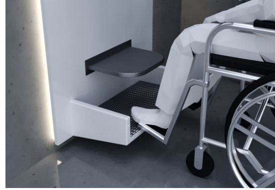
Fig. 16b. Çalışma Kapsamında Tasarlanan Abdest Alma Ünitesi detayları (Tasarım: A. Durukan, İllüstrasyon B. Sarıkcıoğlu)
