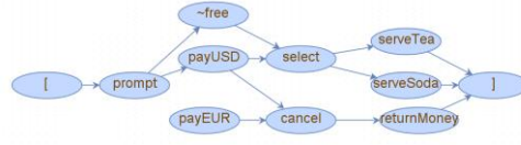
Şekil 9. Statik kenar eşleme durumunda fullProduct OSÇ'den payEUR özelliğinin eksiltilmesiyle elde edilen OSÇ
