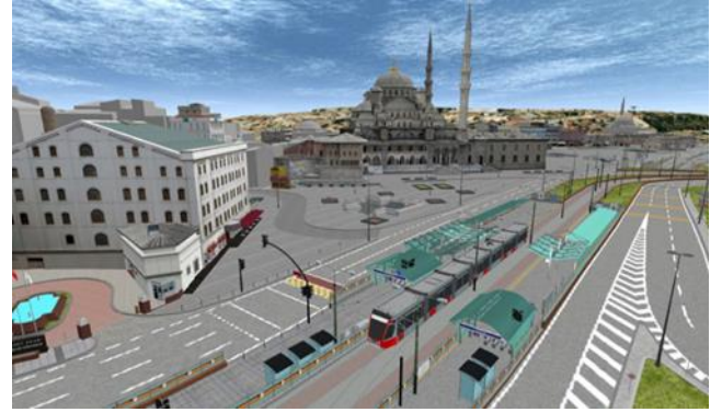
Şekil 7. LoD3 modellenen binaların ve ayrıntılı katı zemin modelinin birleştirilmiş hali
