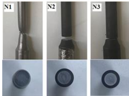
Şekil 7. Numunelerin kopma bölgeleri (The rupture regions of the samples)
