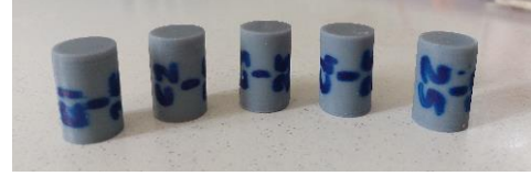
(a) %25 doluluk oranlı basma numunesi
