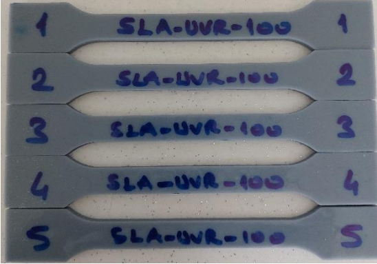
(c) %100 doluluk oranlı çekme numunesi
