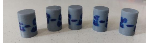
(b) %50 doluluk oranlı basma numunesi
