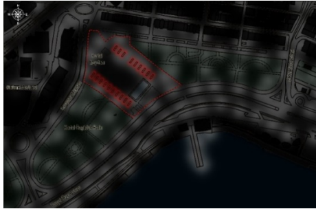
Şekil 11. Kartal Meydan Parkı Aydınlatma Analizi (Altlık: Kartal Belediyesi verilerinden yazarlar tarafından üretilmiştir.)
