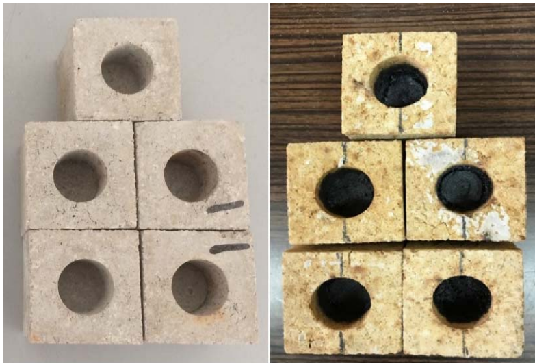
Şekil 8. Cüruf Tozu Şarj Edilmiş Numunelerin Pişirme İşlemi Öncesi (sol) ve Sonrası (sağ) Görünümleri (Views of Slag Powders Charged Samples Before (left) and After (right) Baking Process)
