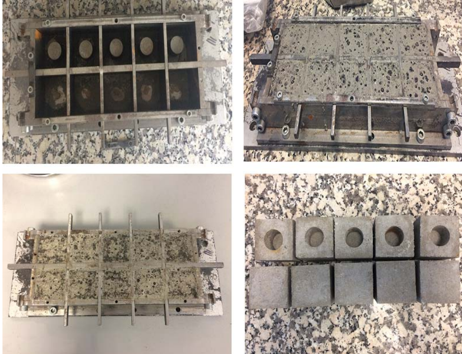
Şekil 2. Şekillendirme Kalıbı (üst sol) , Massenin Vibrasyonlu Kalıba Dökümü (üst sağ), Betonun Priz Alması Süreci (alt sol), Kütleleme ve Kurutma Tavlama Sonrası Refrakterler (alt sağ) (Shaping Mold (above left), Masse's Vibratory Mold Casting (above right), Setting Process of Concrete (below left), Refractory Concrete Samples Obtained After Curing and Drying (below right))
