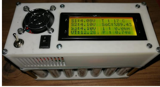
Şekil 6. Tasarlanan BYS sisteminin genel görünümü.
