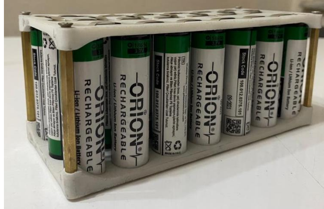
Şekil 3. Montajı tamamlanan pil paketi.
