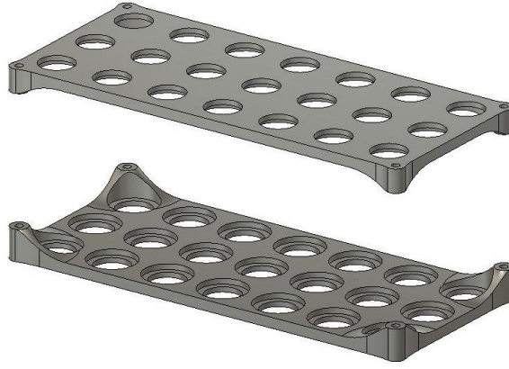
Şekil 2. Tasarlanan pil yatağı.
