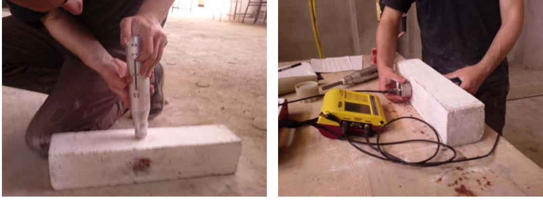
Şekil 2. Kiriş numunelere schmidt ve ultrases deneylerinin yapılması
