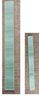
Şekil 2. Stadartlara göre kesilmiş çekme ve basma test numuneleri
