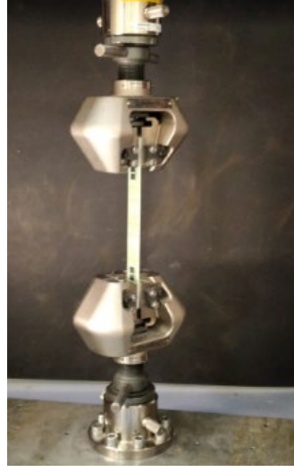
Şekil 4. 1-2 yönü çekme testi
