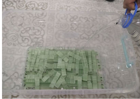
Şekil 3. Numunelerin yaşlandırma işlemine bırakılması
