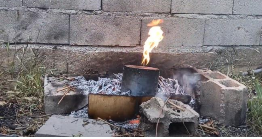
Görsel 3: Teneke dışına tahliye edilen yanıcı odun gazının ateş alması (Fotoğraf: Mustafa Salih Köksal, 05.05.2021).
