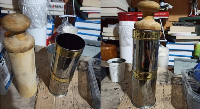
Görsel 13: Barut hamurunu sıkıştırmak için kullanılan teneke silindir ve ahşap tokmak (Fotoğraf: Mustafa Salih Köksal, 16.02.2022).
