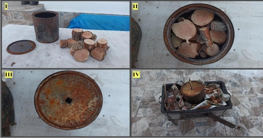
Görsel 2: Odunu ateşe vermeden önce yapılan hazırlıklar. III numaralı görselde odun gazının tahliyesi için açılan delik görülebilir. IV numaralı görsel: Teneke içerisindeki kömürün ateş almaması için delik bir çubuk yardımıyla daraltıldı (Fotoğraf: Mustafa Salih Köksal, 06.02.2022).
