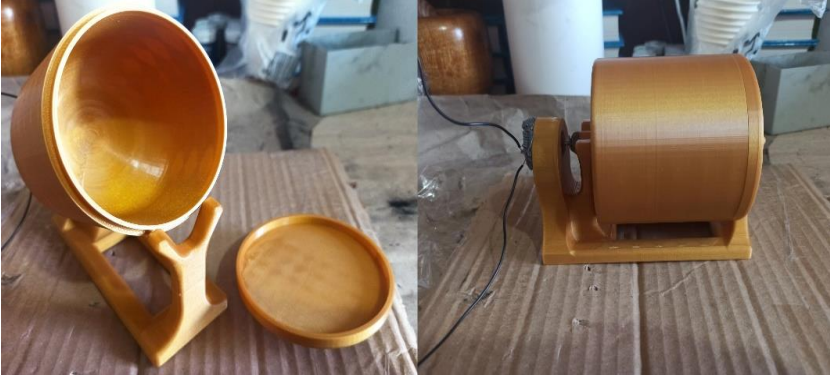
Görsel 12: 3B yazıcı ile üretilen bilyeli değirmen (Fotoğraf: Mustafa Salih Köksal, 16.02.2022).
