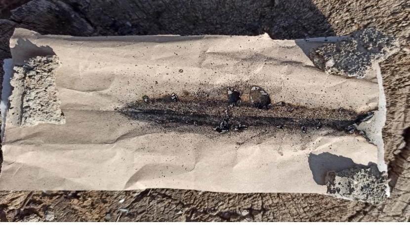
Görsel 10: Daha iyi karıştırılmış serpantin barutun yanma sonrasında bıraktığı iz. Test I'e kıyasla oldukça temiz bir yanma (Fotoğraf: Mustafa Salih Köksal, 18.02.2022).
