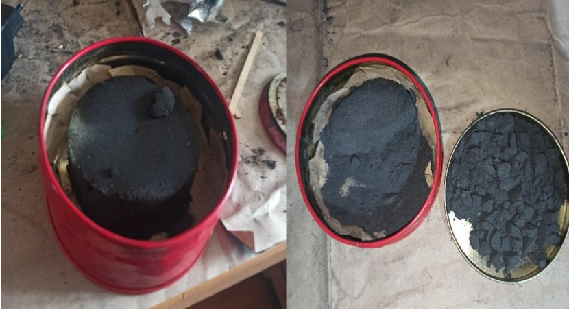
Görsel 15: Presleme sonrası kara barut (solda) ve kara barutun taneli hale getirilmesi (Fotoğraf: Mustafa Salih Köksal, 17.02.2022).
