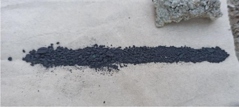
Görsel 11: İnce taneler oluşturacak şekilde granül hale getirilmiş barut örneği (Fotoğraf: Mustafa Salih Köksal, 18.02.2022).
