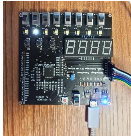
Şekil 13. FPGA geliştirme kartı üzerinde gerçekleştirilen yarım toplayıcı uygulaması (giris1=1 giris2=1 durumu).
