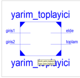
Şekil 8. Yarım Toplayıcı uygulamasına ait RTL şeması
