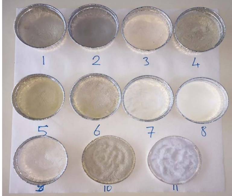
Şekil 1. Çalışmada kullanılan ticari ağartma toprakları ve doğal killer (1-T.A.T.-1, 2-T.A.T.-2, 3-Halloysit, 4-Zeolit, 5-Bentonit, 6-Sepiyolit, 7-Diatom Toprağı, 8-Magnesol XL, 9-Kaolin, 10-Montmorillonit, 11-Perlit)
