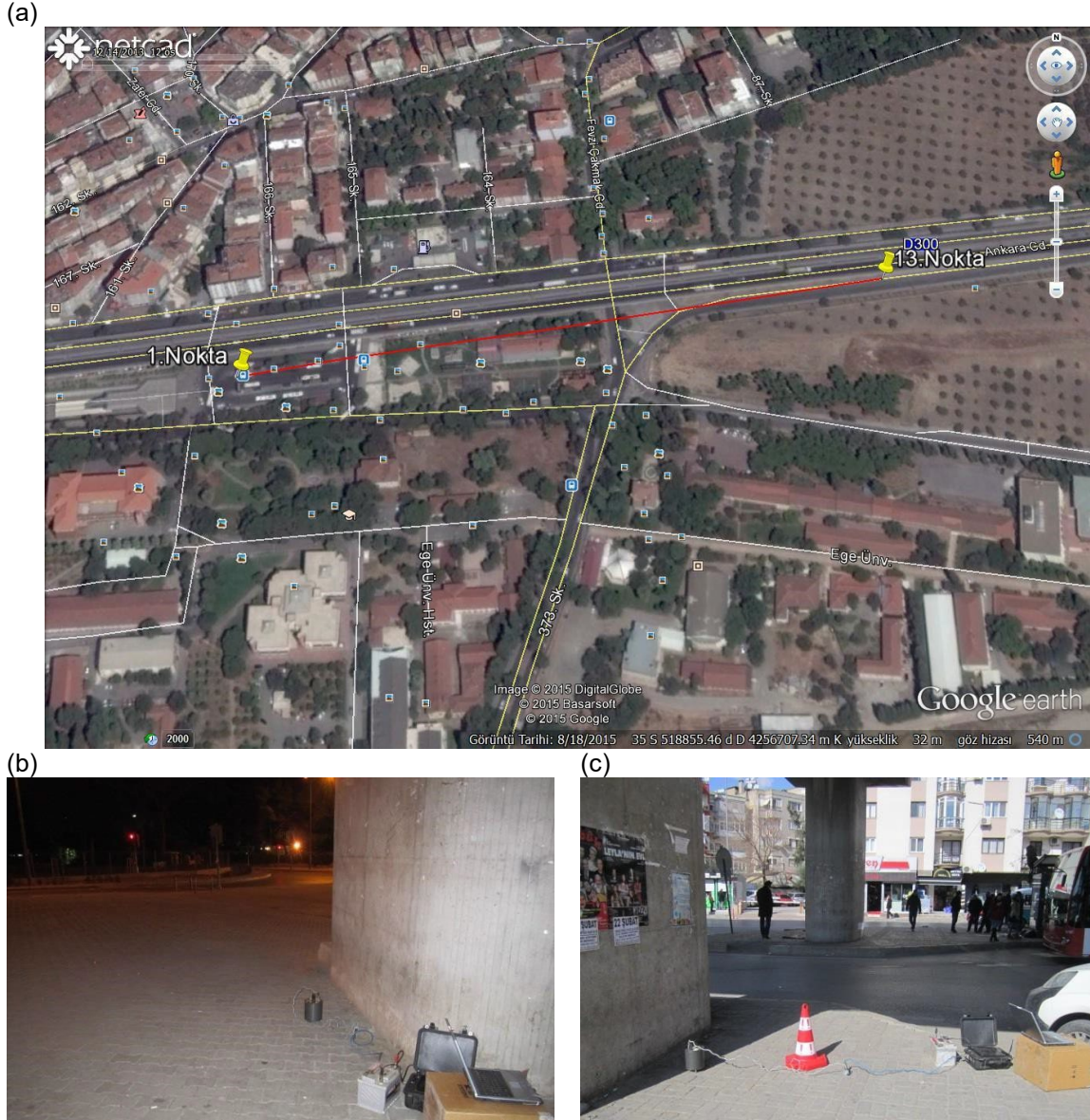
Şekil 2: a) İzmir ili, Bornova ilçesinde bulunan karayolu viyadüğünün konumu ve çalışma alanının uydu görüntüsü, b) Gece, c) Gündüz mikrotremor ölçümleri
